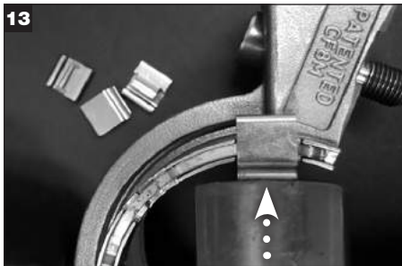
Die alten Federn aus den Dichtungsflanschhälften entfernen, indem sie mit einem kleinen Hammer von der Innenseite der Dichtungsflanschhälfte herausgeklopft werden.
