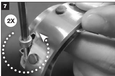
7 Die alten Halter-Sechskantschrauben aus den Halterhälften ausbauen.
