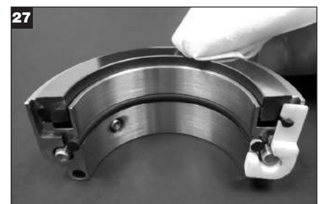
Die Gegenringflächen mit einem Wischtuch reinigen.
