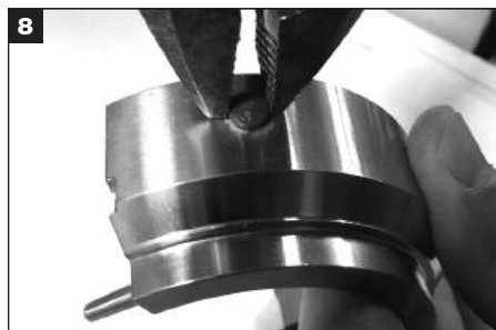
8 Die alten Zentrierknöpfe aus dem Außendurchmesser des Gegenringhalters ausbauen.
