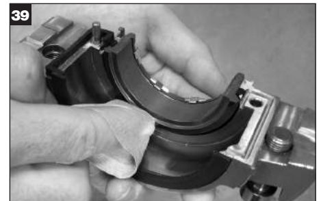
Die Gleitringsflächenhälften mit einem Wischtuch reinigen, um sicherzustellen, dass auf der Gleitfläche und an den Teilfugen keine Verunreinigungen vorhanden sind.
