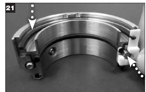
Die Transportdistanzstücke des Gegenringhalters in die Gegenringhalterhälften einbauen, damit der O-Ring der Gegenringfläche gehalten wird.
