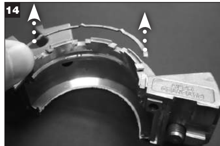
Die Hubfederhälften aus den Dichtungsflanschhälften entfernen.
