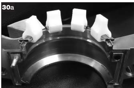
Hubfederspannen in die Dichtungsflanschkhälften eingebaut.
