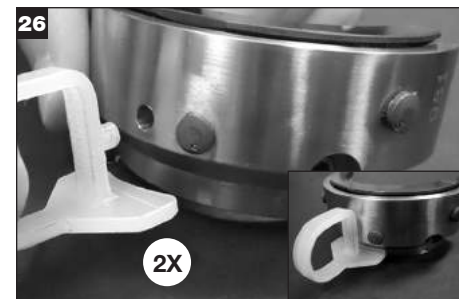
Die Montagedistanzstücke am Außendurchmesser der Halterhälften einbauen.
