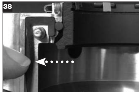
Eine dünne Fettschicht auf die Dichtungsflansch-Dichtungen auftragen und diese in die Rillen der Dichtungsflanschkhälften einbauen. Hinweis: Dichtungsflansch-Dichtungen müssen an dem Dichtungsflanschende montiert werden, an dem die Dichtraumdichtung hervorsteht.
