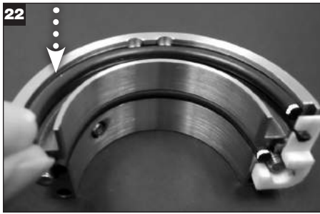
Eine dünne Schicht Schmierfett auftragen und die Gegenring-O-Ring-Hälften in die Gegenringhalterhälften einbauen.
