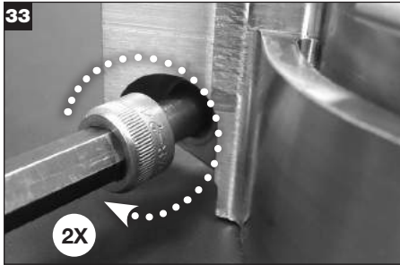
Die neuen Dichtungsflansch-Sechskantschrauben in die Dichtungsflanschkhälften einbauen. Hinweis: Die Dichtungsflansch-Sechskantschrauben werden an einem Ende jeder Dichtungsflanschkhälfte eingebaut, und zwar an den vom Befestigungsschraubenschlitz entfernten Seiten.
