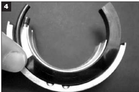
4 Die alten Gegenringhälften entfernen, indem ein Ende der Fläche angedrückt und aus der Gegenringhalterhälfte herausgeschoben wird.
