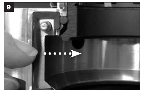
9 Die alten Dichtungsflansch-Dichtungen aus den Dichtungsflanschrillen ausbauen.
